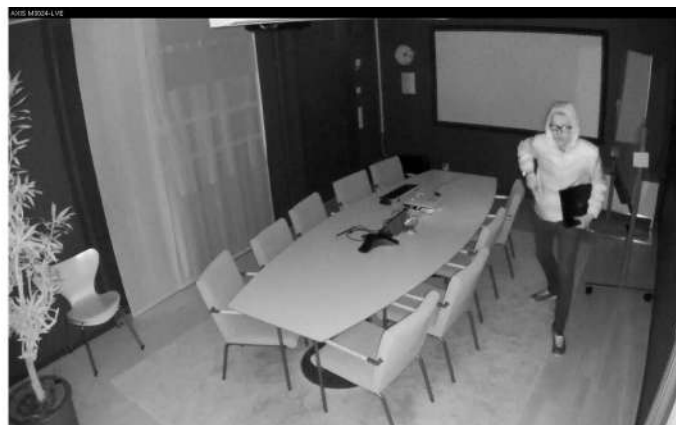
上方由 AXIS M3024-LVE 拍攝的影像所描繪的是相同的場景：在黑暗的房間中有一個男人帶著一支小手電筒。從這兩張影像中可以看出紅外線照明對於在暗處監控所造成的差異。左側的影像並未使用紅外線照明。右側的影像使用了攝影機內建紅外線 LED 的紅外光。紅外光對於人眼而言是不可見光，但是攝影機可以捕捉到這種光線。
